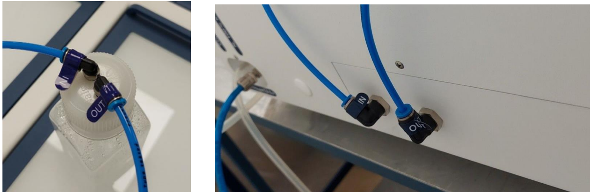
Figur 23.1 Slanganslutning på befuktningensflaskan och MIRI® Humidity IVF-inkubatorn med flera kammare
