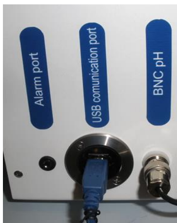
Figur 20.1 pH-sond ansluten till BNC-kontakten
